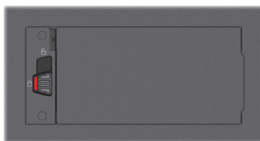
Mauvaise position (partie rouge est visible)
